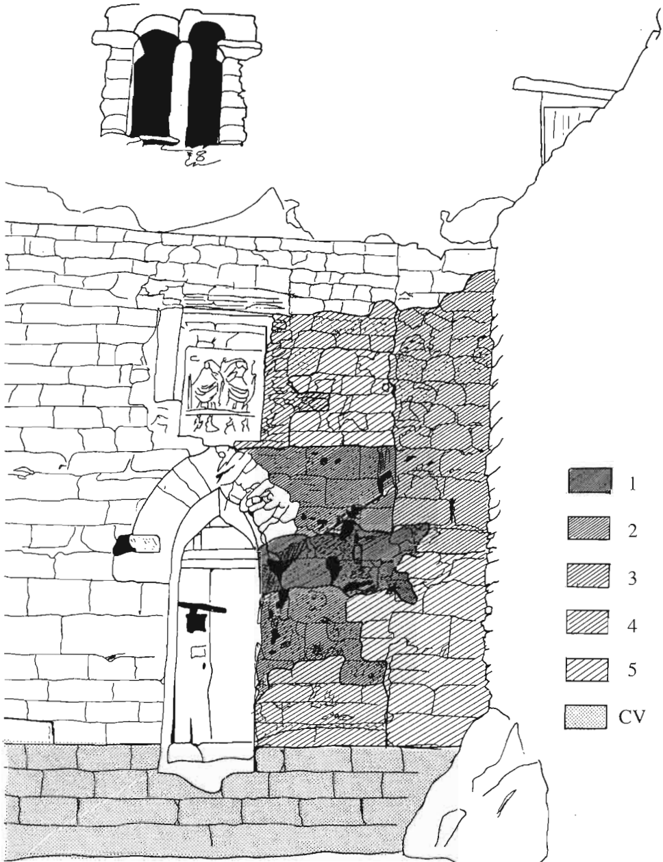
Fig. 2. Esquema de la puerta de la cárcel (fachada este de la colegiata de Alquézar), donde se reseñan las distintas alteraciones ordenadas de mayor a menor grado. CV: colonización vegetal.
