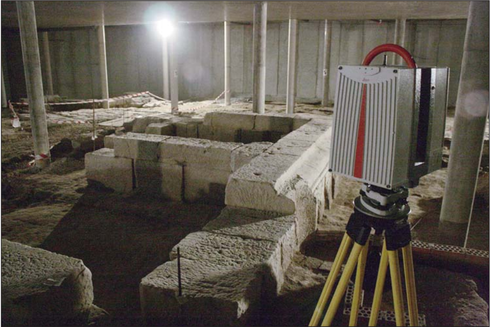
Fig. 3. Proceso de documentación del escáner láser 3D de diferencia de fase en los restos romanos.
