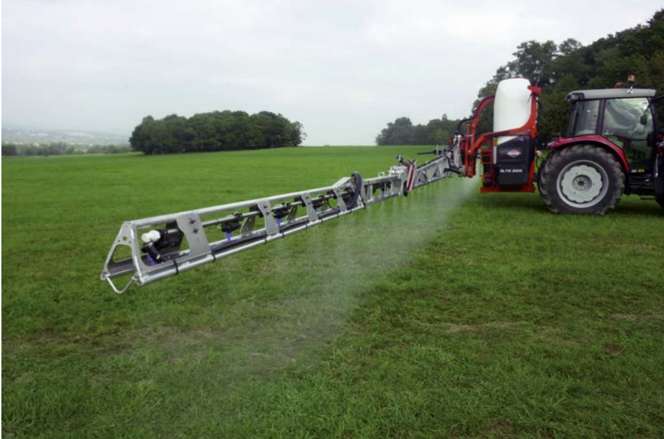
Fig. 1. Pulverizador hidráulico de barra con estructura en aluminio.
