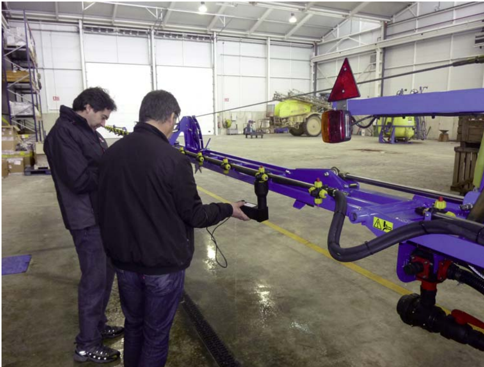
Fig. 10. Medida de caudal en boquillas de barra de pulverizador hidráulico utilizando un caudalímetro digital.
