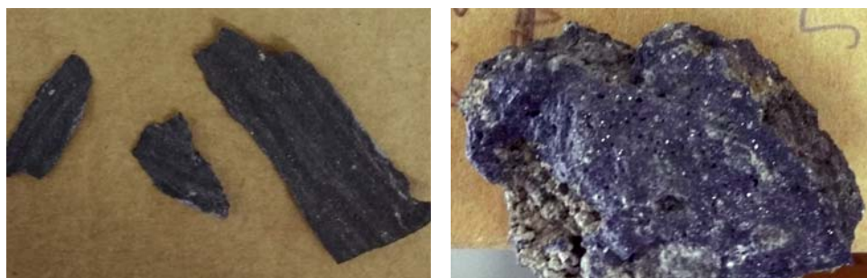
Fig. 8. Muestras de mineral (izquierda) y de escoria (derecha) de Tramarius.
