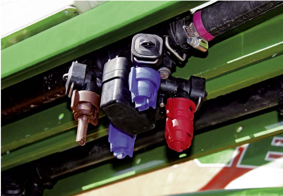
Fig. 7. Sistema Amaselect de Amazone para la selección de la boquilla de trabajo, equipado con diferentes tipos de boquillas.
