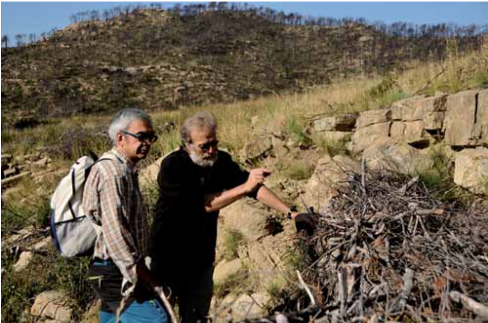
Fig. 7. Evaluando la efectividad de las fajinas (en Luna, Cinco Villas) como fijadoras del suelo en zonas forestales afectadas por incendios con el doctor Peter Robichaud del US Forest Service. (Foto: Antonio Girona)
