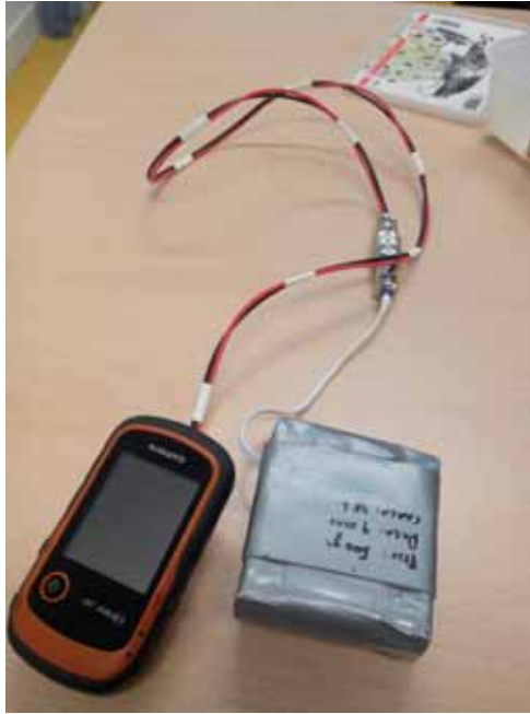
Fig. 1. Dispositivo GPS y batería externa acoplada mediante sistema de cableado.
