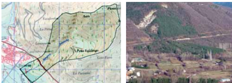
Fig. 2. Cuenca vertiente al torrente de Arratiecho. Izquierda: límites de la cuenca, su proximidad al núcleo de población de Biescas y paso por su área dominada de la carretera N-260. Derecha: vista del cono de sedimentación del torrente y del trazado de la N-260 por el mismo, en marzo de 2012.
