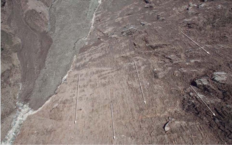
**Fig. 17.** Límite de la avalancha, túnel de desagüe del río y árboles caídos que indican la dirección de la onda expansiva.
