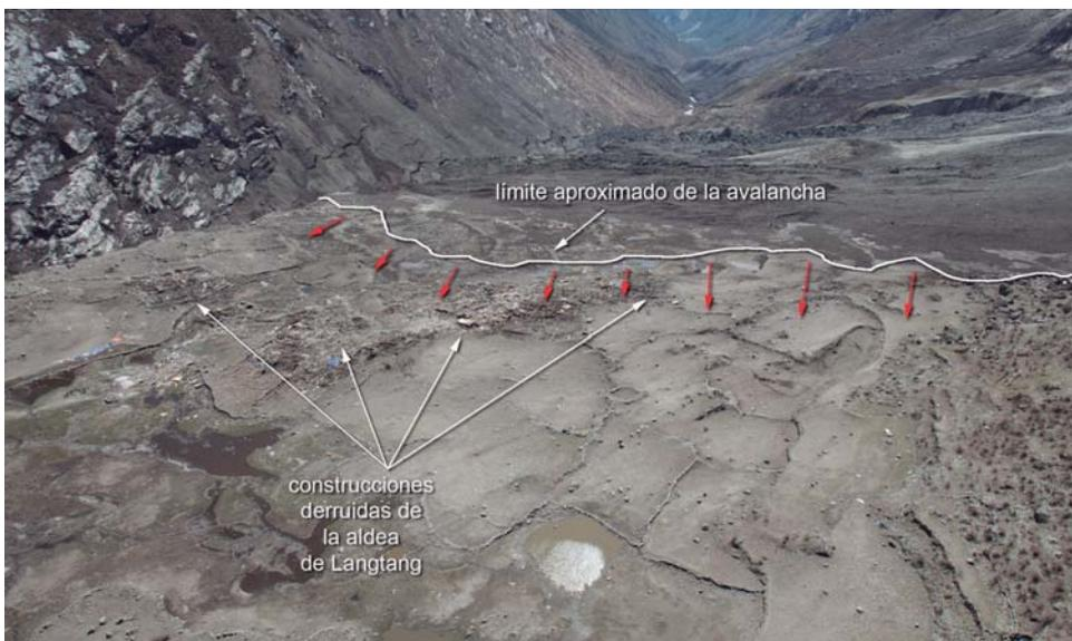
**Fig. 13.** Límite este de la avalancha de Langtang. Se observa el efecto de la onda expansiva que afectó y derribó lateralmente las edificaciones ya destruidas por el terremoto.
