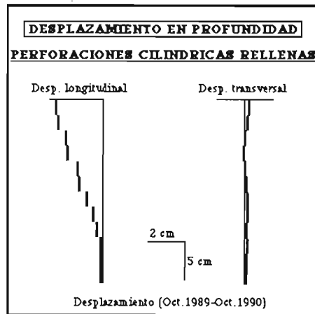
Fig. 5. Desplazamientos por movimientos en masa lentos en la parcela experimental n.º 2 (Ermita de las Aras), durante el período octubre 1989 - octubre 1990.
