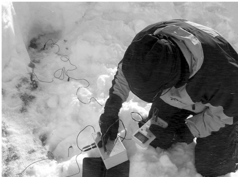
**Fig. 3.** Determinación de la conductividad eléctrica del suelo.
