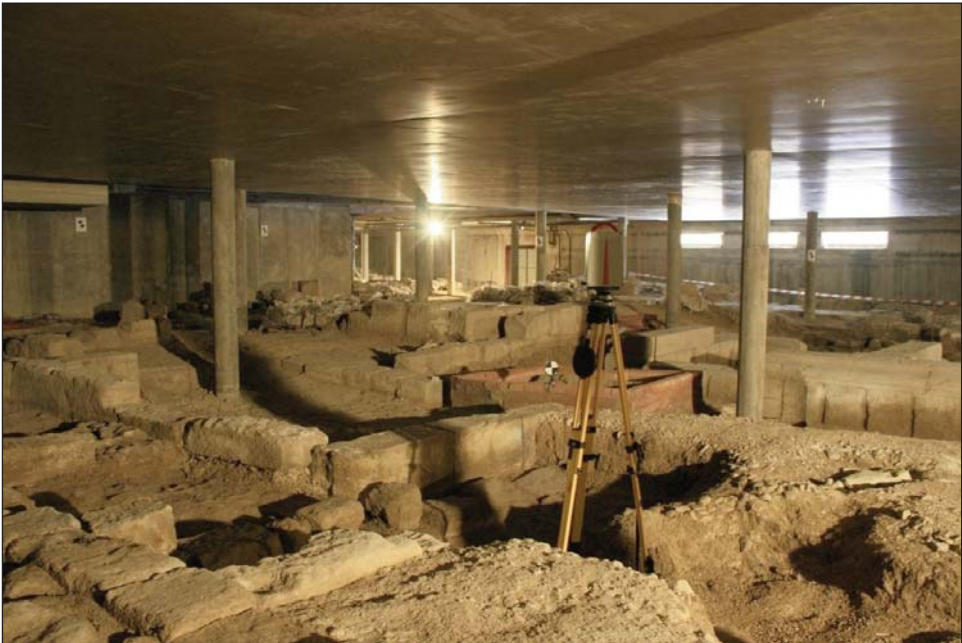
Fig. 1. Vista del conjunto de los restos romanos del Círculo Católico. Proceso de documentación mediante escáner láser 3D de diferencia de fase modelo Leica HDS 6100.
