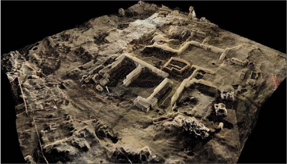
Fig. 5. Ejemplo de nube de puntos registrada de todo el conjunto con una resolución de 3 milímetros.
