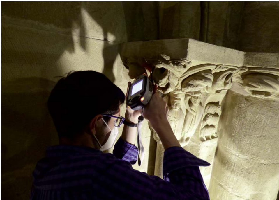
Fig. 4. Análisis mediante pXRF en un capitel de la Sala de Doña Petronila del Museo de Huesca.
