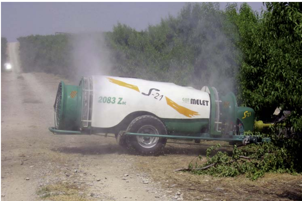
Fig. 2. Pulverizador hidroneumático con doble ventilador (trasero y delantero).
