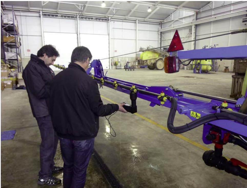
Fig. 10. Medida de caudal en boquillas de barra de pulverizador hidráulico utilizando un caudalímetro digital.
