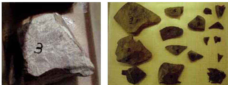
Fig. 7a. Bloque inalterado (izquierda) y resultado de su fragmentación (derecha) tras un ciclo de humectación-secado.
