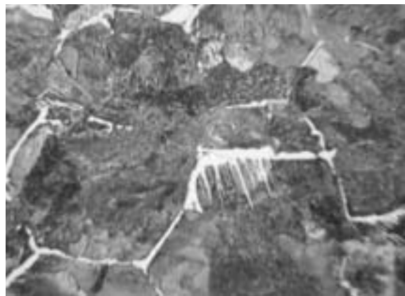
Fig. 15. Detalle de microestructura de alto contenido en carbono (X 300).
