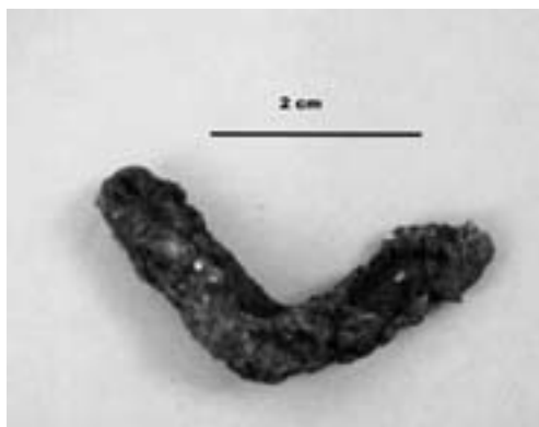
Fig. 13. Macrografía de la curva del clavo.
