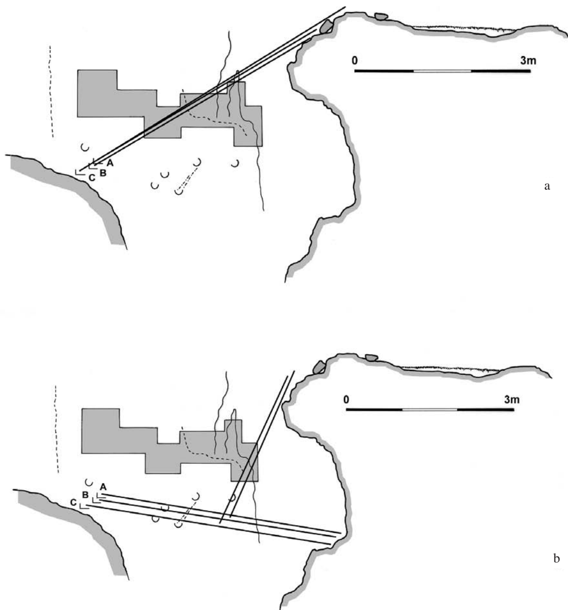
Fig. 9. Dos propuestas de construcción del andamio para acceder a la plataforma colgada II B.
