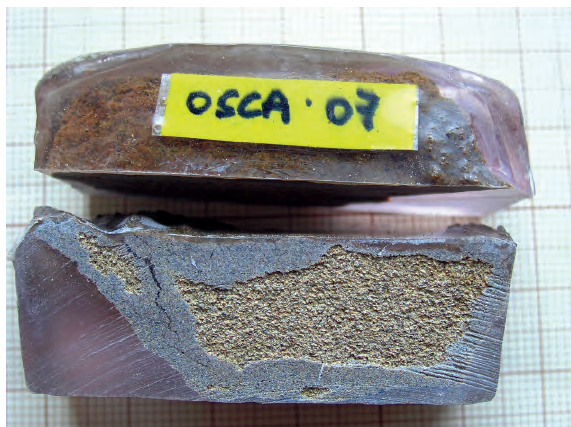
Fig. 4. Muestra consolidada con una resina epoxy para facilitar el corte de la sección.
