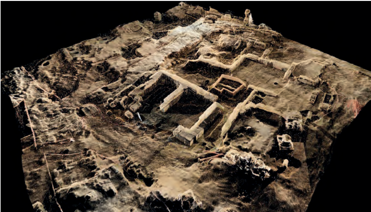
Fig. 1. Ejemplo de nube de puntos registrada de todo el conjunto con una resolución de 3 mm. Imagen realizada por J. Angas y A. Serreta.
