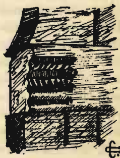
Molduraje de la imposta del arco del claustro de San Juan de la Peña. Corresponde a la derecha (entrando) y es el único que conserva sus sogueados después del incendio.
