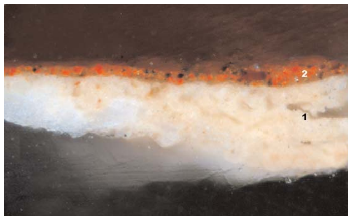
Tercera micromuestra: 1. Capa de preparación. 2. Capa de pintura.
