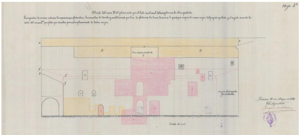
Secciones y alzados interiores del ala norte interior con la obra realizada según el presupuesto adicional de la comisión y alzado de la nave oeste tras el derribo de la galería claustral.
