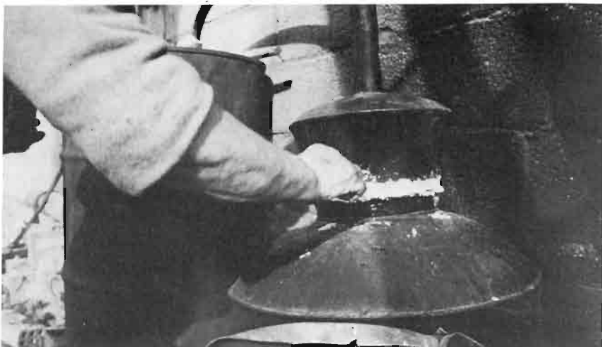
Foto núm. 3: Colocación de la pasta para evitar escapes de vapor. (F. A. Castelló, 1984).
