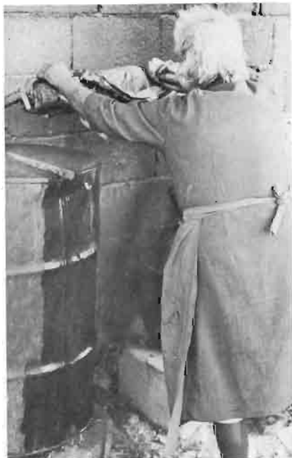
Foto núm. 4: Envolviendo el serpentín con paños mojados para rebajar la temperatura. (F. A. Castelló, 1984).
