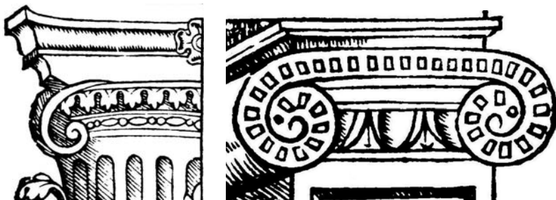
Figs. 16 y 17. Detalle de capitel itálico y de pilar jónico según Sagredo (Medidas del Romano, edición de 1549).
