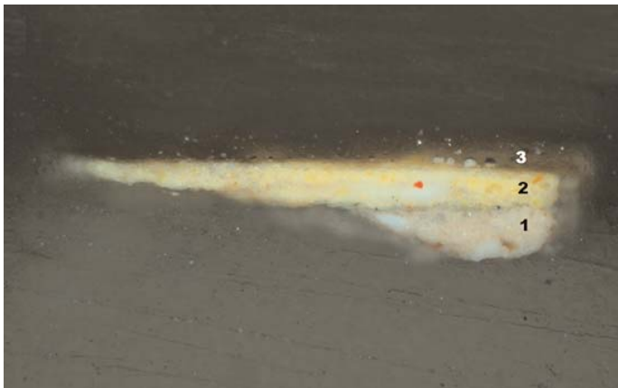
Segunda micromuestra: 1. Capa de preparación. 2. Capa de pintura. 3. Barniz translúcido.
