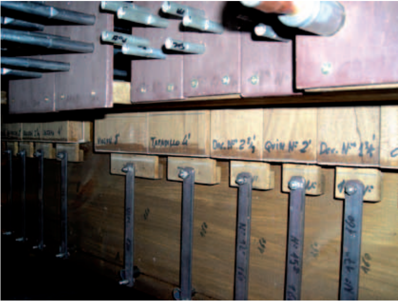
Vista lateral de las correderas.
