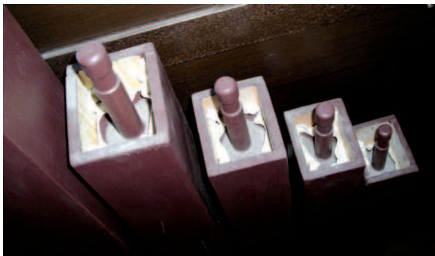
Detalle de los tubos tapados del pedal de bordón 16' vistos desde arriba.
