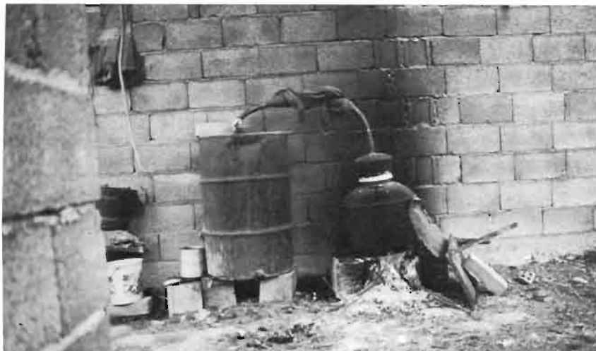
Foto núm. 1: Conjunto completo del destilador. El serpentín está sumergido dentro del bidón. (F. A. Castelló, 1984).
